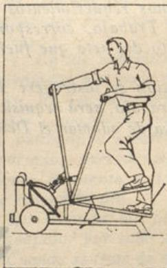
Fig. 1.<sup>a</sup>—Dispositivo de palancas de mano y pie.
